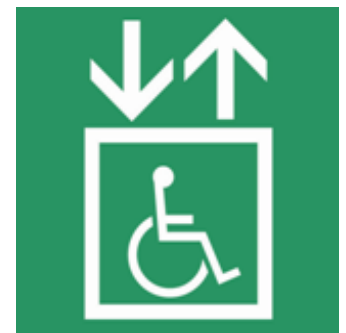
図3 避難誘導用エレベーター標識
